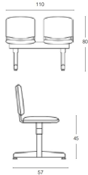
**DESCRIZIONE** : Sedia su barra da 2 a 4 posti, predisposta per fissaggio a pavimento
